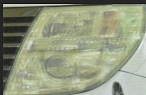
①**施工前** ヘッドライトのトップコートの劣化やひび割れに汚れが入り込み、黄ばみで曇っている状態。
